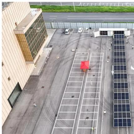
[Romania 4x46KW Foldable Photovoltaic Container System](#)
